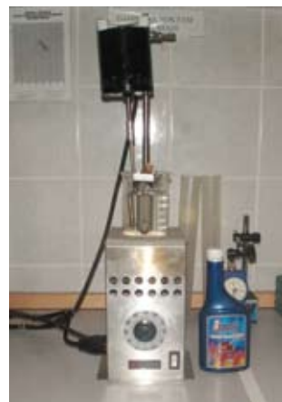
Koçak Speedol Laboratuvarında bulunan bu cihazla greslerin damlama noktası ölçümleri yapılabilmektedir.
